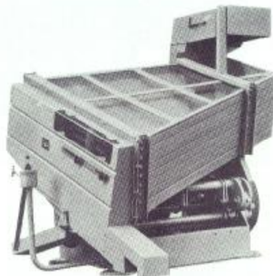
Fig. 23. Tray-type paddy separator.
